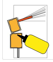
Positionner le flanc qui doit recouvrir les deux blocs, son gabarit de découpe doit être par dessus. Exercer une légère pression sur la pièce.
