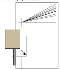
Placer le bloc du haut sur le gabarit tel que la tige soit alignée sur le trait ayant le code de la pièce à réaliser
