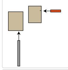
Placer le bloc du bas sur le gabarit comme indiqué. Le tige doit parfaitement se superposer au dessin.
